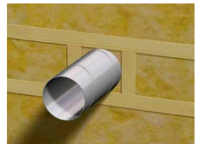
Understøttelse rundt om gennemføringer
