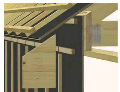
Overgang væg/tag med løs spærende
