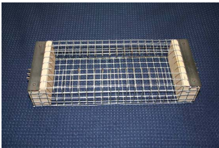
Bilde av prøvekurv for testing av løstull-isolasjon.
